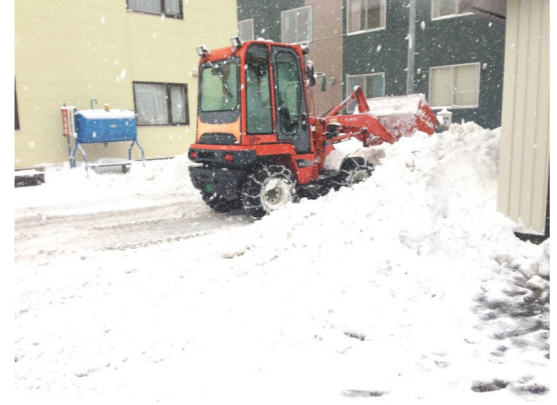
タイヤショベルを使用してわっくわくの周辺を除雪しているところ
