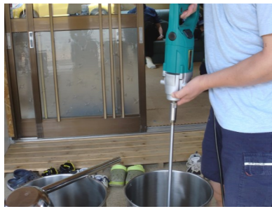
6月、廃油、水と苛性ソーダを混ぜる。機械により仕事がスムーズ
