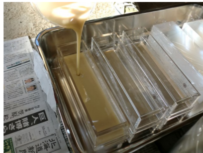
混ぜた材料をすぐ型枠に流し込む
